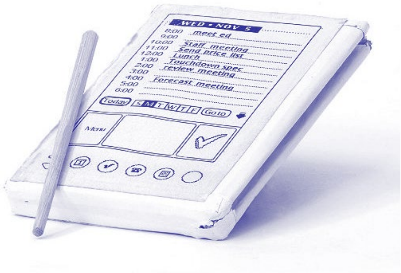
Figure 16 : Maquette en bois du futur Palm Pilot, le plus simple des artefacts ! (Source : Palm / Computer History Museum)
